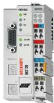
Коплер серии BK, связь между промышленной шиной и модулями ввода/вывода
