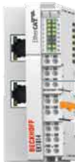
EtherCAT коплеры с интегрированными цифровыми входами/выходами
