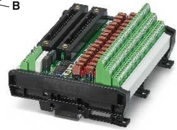
Модуль ввода 24 В пост. тона
