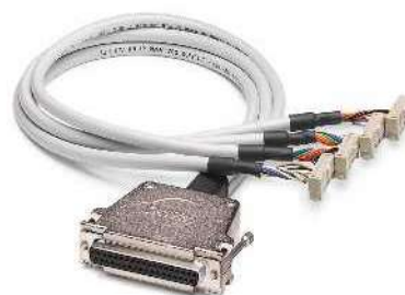
Разветвительный кабель, гнездовая планка D-SUB на гнездовой планке IDC/FLK, количество контактов: 37 на 4 x 14
