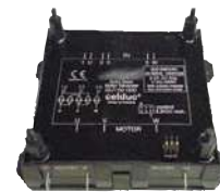
Реверсор электродвигателя с 2 электронными платами и 5 твердотельными реле.
