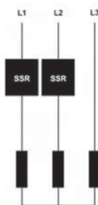
Двухфазное ТТР SOB для контроля нагревательных элементов, соединенных звездой (для сбалансированных нагрузок низкого напряжения без нейтрали)
