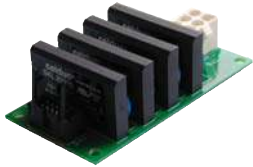
4 твердотельных реле SKL на печатной плате
