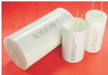
Предназначены для работы в схемах однофазных двигателей в качестве пусковых или рабочих и при использовании трехфазных асинхронных электродвигателей в качестве однофазных (аналог К-78, К-42). Применяются в цепях переменного, пульсирующего и постоянного тока. Изготавливаются на основе самовосстанавливающейся полимерной металлизированной пленки.
