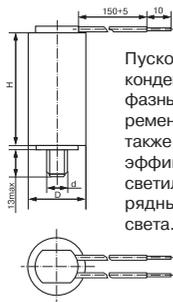
Пусковые и рабочие конденсаторы для однофазных двигателей переменного тока, служат также для улучшения коэффициента мощности светильников с газоразрядными источниками света.
