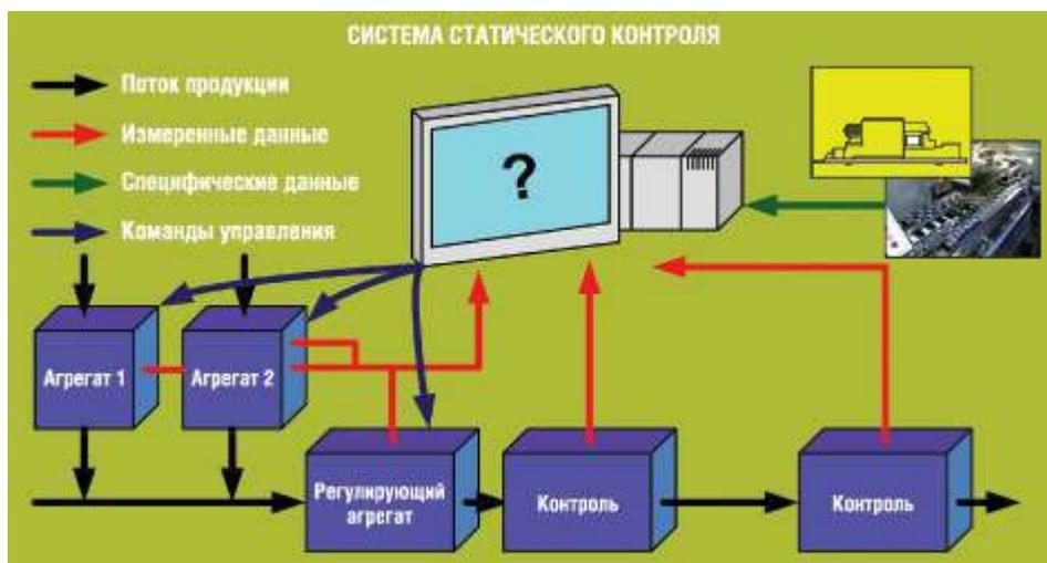
Рис. 2. Автоматическая настройка производственных процессов в процессе контроля качества
