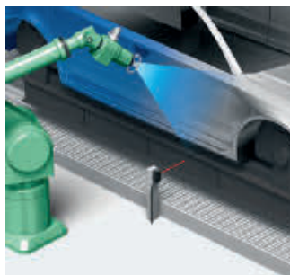
Рабочая поверхность датчика загрязняется краской
