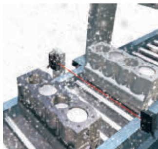
На рабочей поверхности датчика скапливаются мусор и пыль
