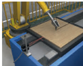
Обнаружение заготовки в деревообрабатывающем станке
