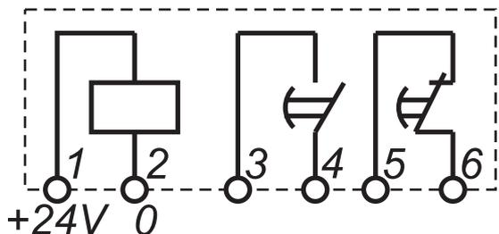
**Рисунок 7** - Схема подключения ВЛ-67 на напряжение 24 В
