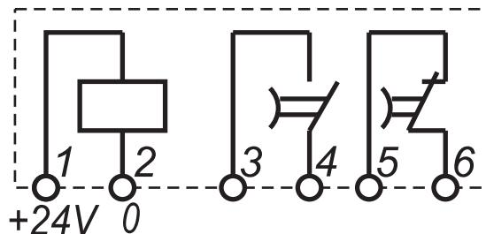
**Рисунок 4** - Схема подключения реле ВЛ-64, ВЛ-66, ВЛ-68, ВЛ-69 на напряжение 24 В
