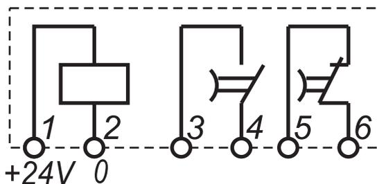
**Рисунок 4** - Схема подключения реле ВЛ-64, ВЛ-66, ВЛ-68, ВЛ-69 на напряжение 24 В
