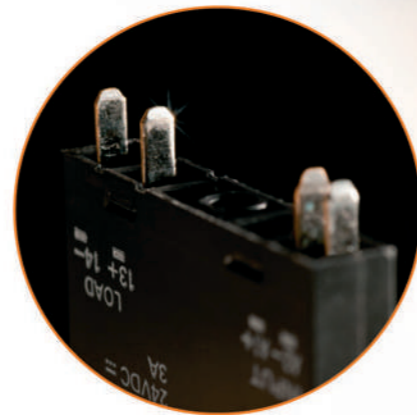
Большие безвинтовые клеммы
