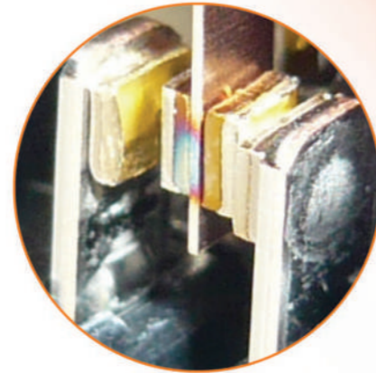
Покрытые золотом контакты для оптимальной защиты.
