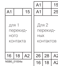
Втычной цоколь LZx: MR78750 для реле времени 7PV33; 7PV4. Втычной цоколь 7PX9921 для реле времени 7PV33; 7PV4.
