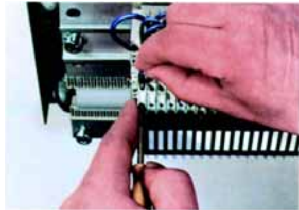
Подключение провода к пружинному контактному зажиму
